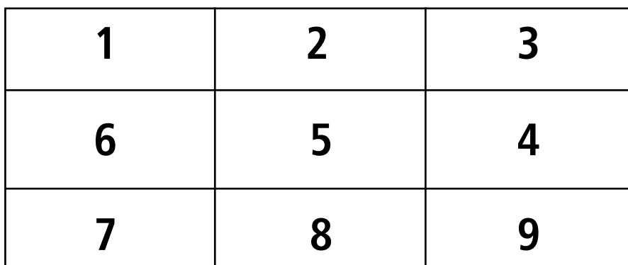
Figura 1. Diagrama de la secuencia seleccionada para medir los niveles de presión sonora por cada cuadrante.
