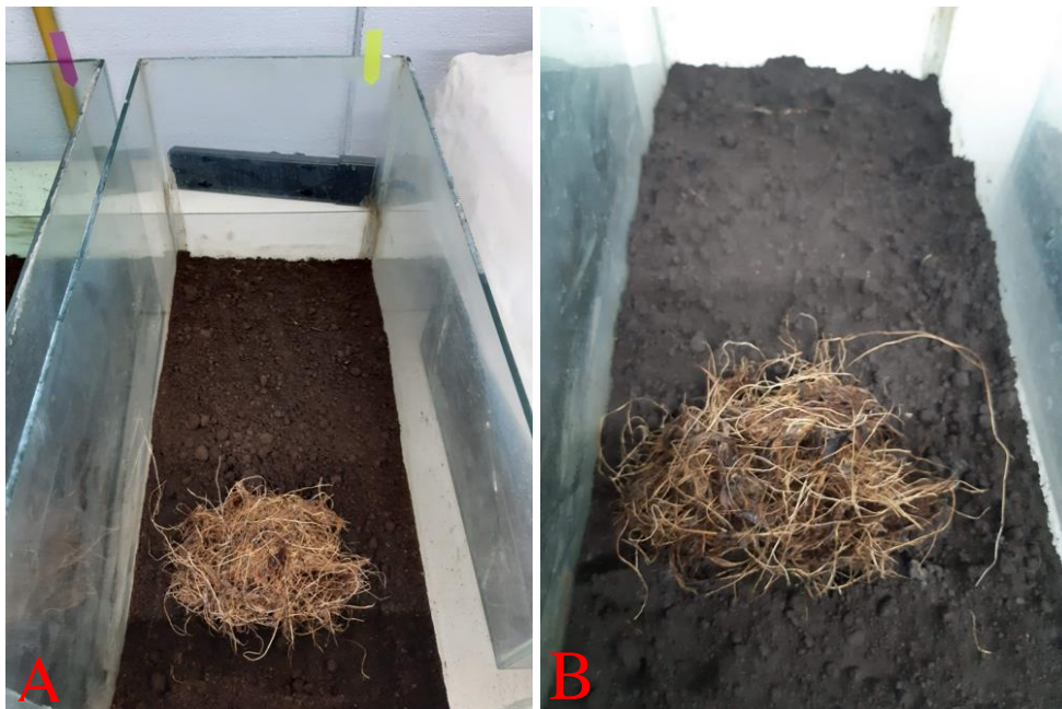
Figura 24. Ensayo en medio sólido fibra sin microorganismo. A: Semana 2; B: Semana 8.
