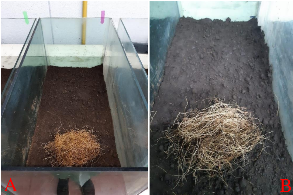
Figura 24. Ensayo en medio sólido fibra sin microorganismo. A: Semana 2; B: Semana 8.
