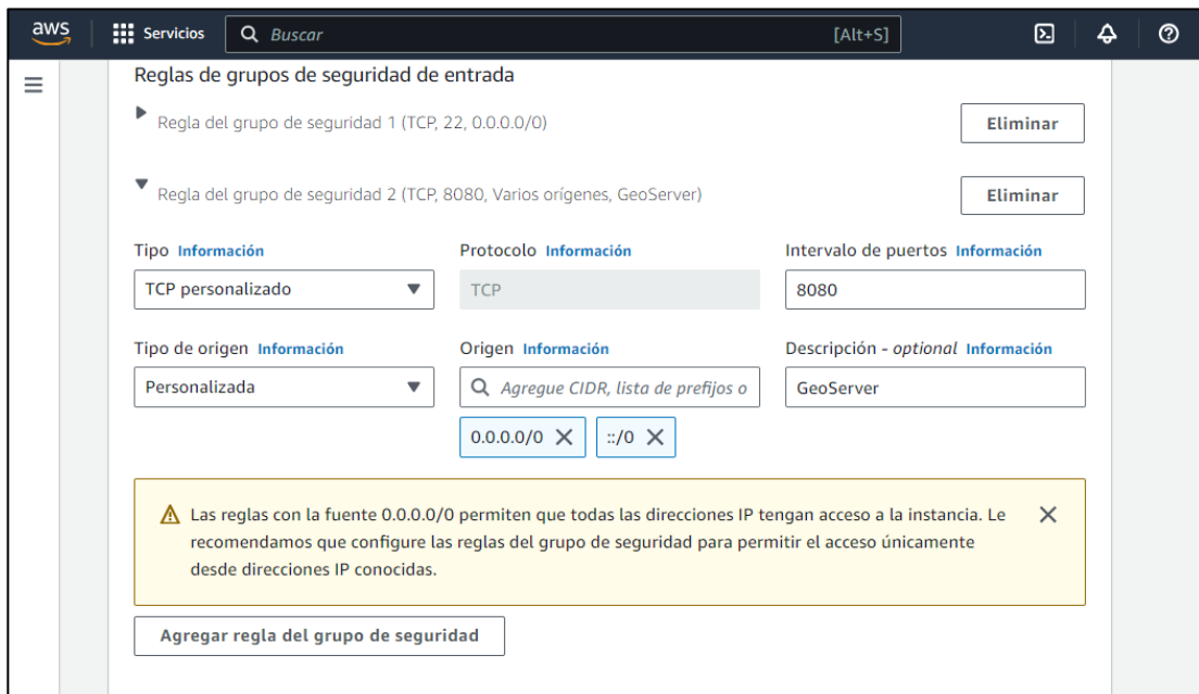
Figura 4.6. Configuración establecimiento de la regla de seguridad.
