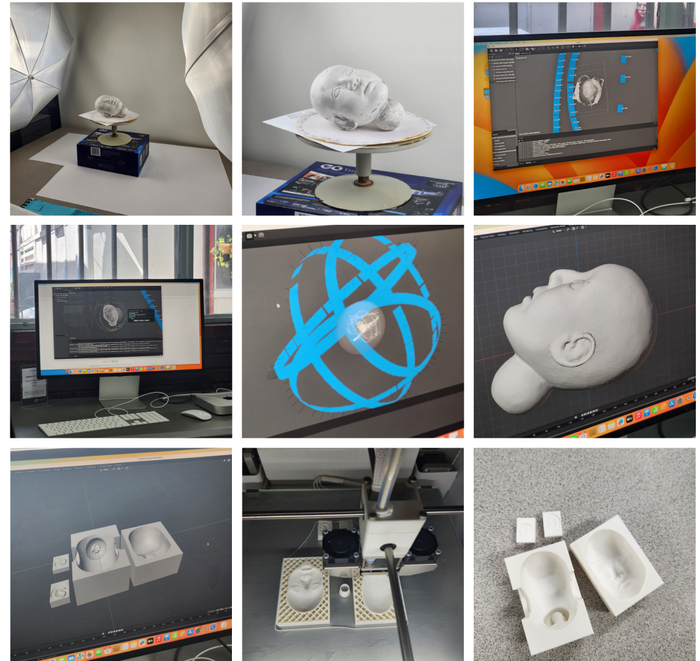
Fig 20. Procesos para el molde de impresora 3d.
