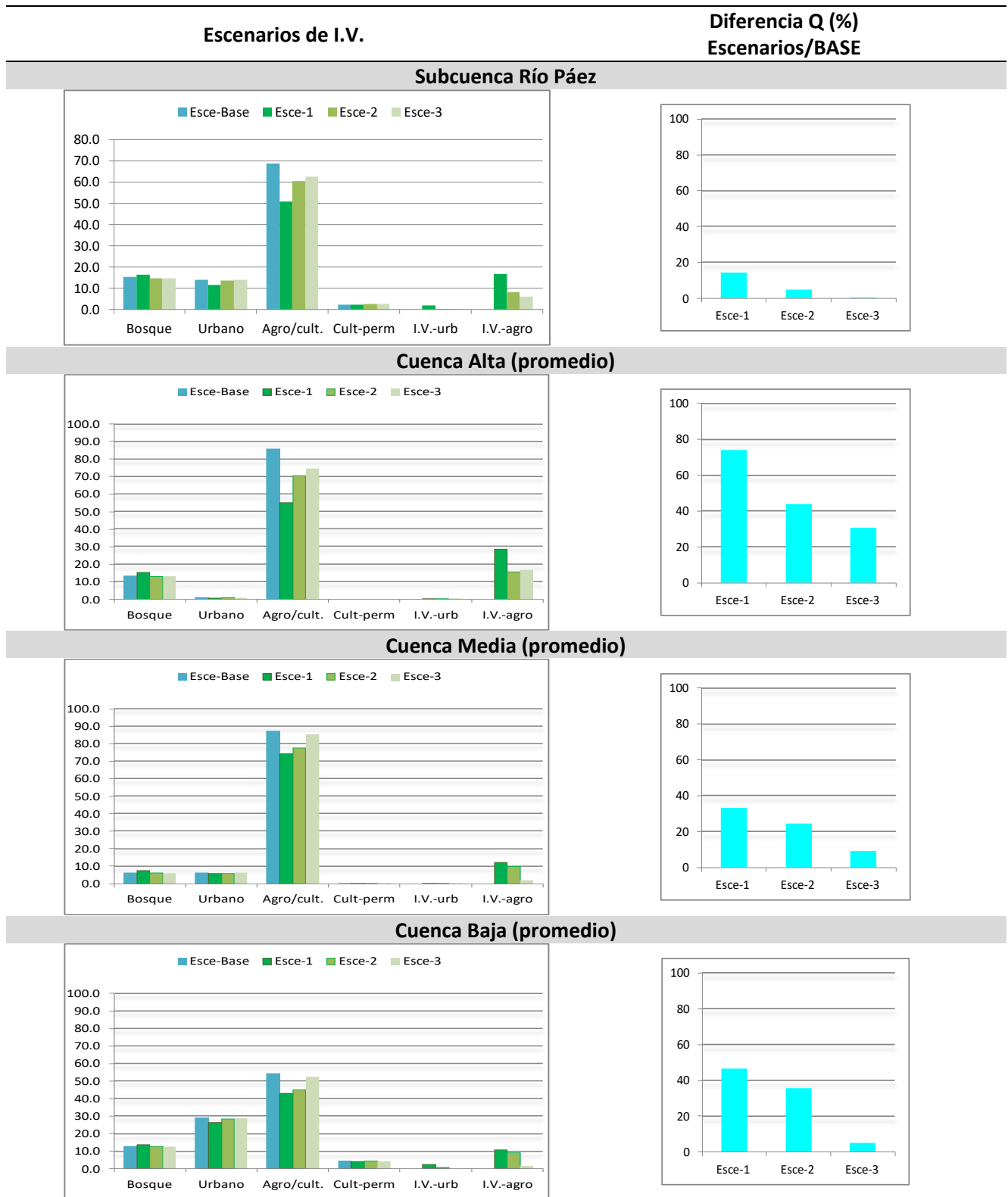
Cuadro 20. Porcentaje de superficie de cada polígono de uso de la tierra y porcentaje de disminución de la escorrentía base por escenario de I.V. propuesto, subcuenca río Páez
