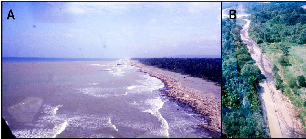
Fig. 4: Decantación, sedimentación y depósitos de biomasa en la periferia de la desembocadura del río Banano (A) y en el Canal de Parismina, cerca de la localidad de Matina (B). En este último caso se aprecia el levantamiento continental y el inicio del proceso de dragado. Fotografías tomadas durante un sobrevuelo en helicóptero por Sergio Mora Castro el 3 de mayo de 1991.
