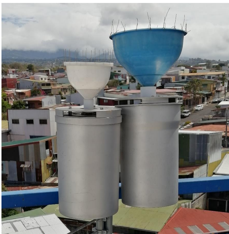
Figura 2. Sistema de muestreo utilizado para la recolección de muestras de agua de lluvia (muestreador ubicado a la derecha con embudo azul).
