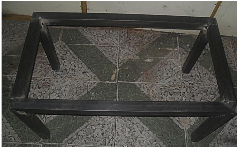
Figura 56 Armazón de tubo galvanizado
