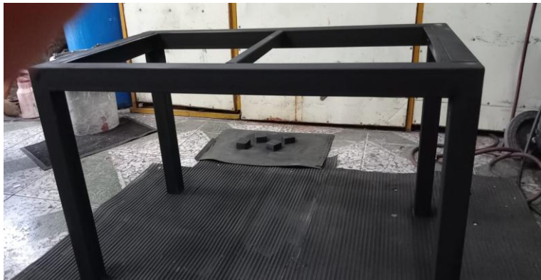
Figura 57 Banca estructura preparada con pintura anticorrosiva
