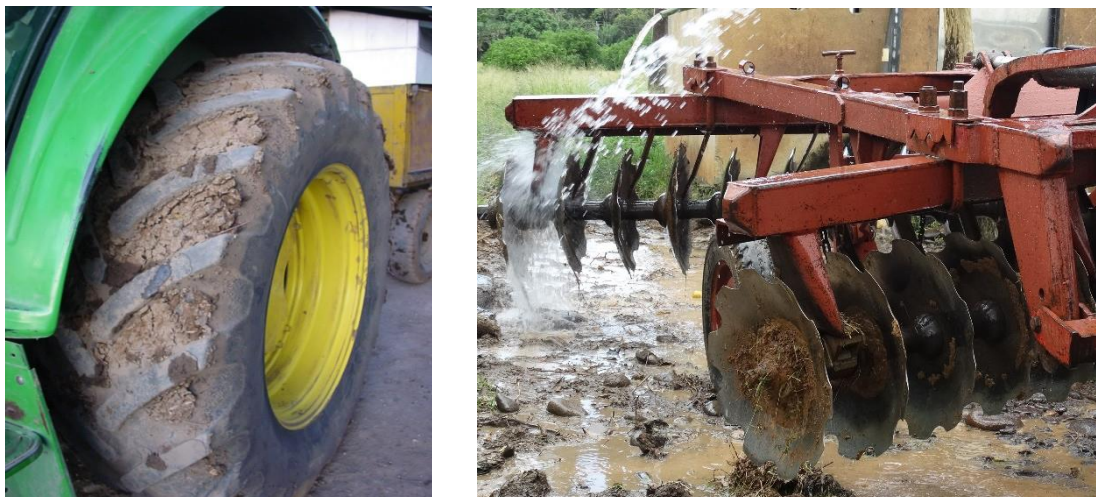
Figura 5. Equipos mecánicos con restos de suelo, posible fuente de dispersión de diversas plagas.
