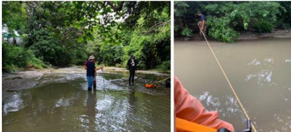
Figura 6.20. Observación de las condiciones del río para la elección de la sección transversal y colocación de la cuerda en la sección transversal. Fuente: Araya, 2023
