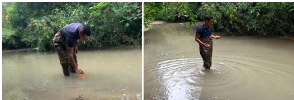
Figura 6.21. Lanzamientos de flotador. Fuente: Araya, 2023
