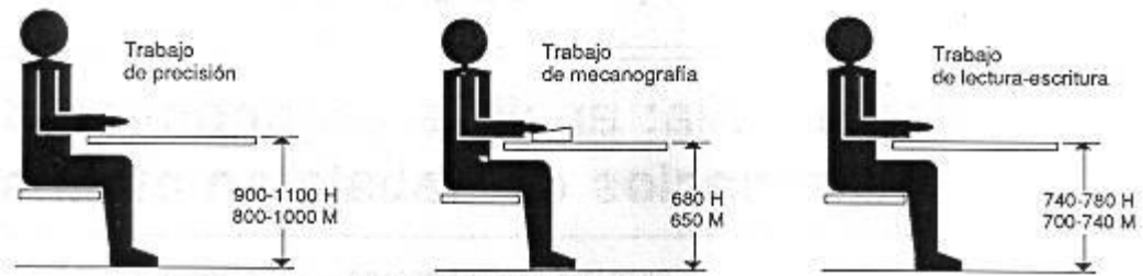
Figura 15. Altura del plano de trabajo para puestos de trabajo sentado (medidas en mm). Fuente: www.siafa.com.ar/notas/nota145/ergonomia.htm
