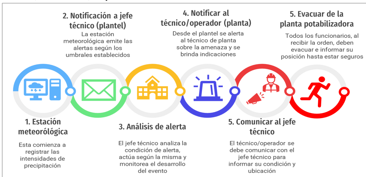
Figura 28. Proceso de comunicación/difusión de la alerta del protocolo SAT de La Paz, San Ramón, Alajuela.
