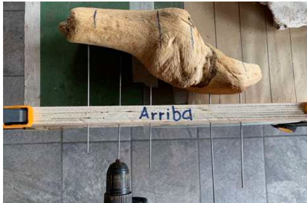
Figura. 56 Guía de madera y pines de metal
