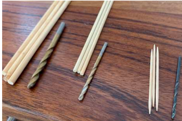
Figura. 32 Calibre de brocas y pasadores
