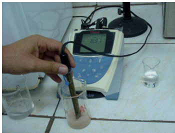
Figura 8. Medición de pH en carne de corvina picuda ( C. phoxocephalus ) con pH-Metro.
