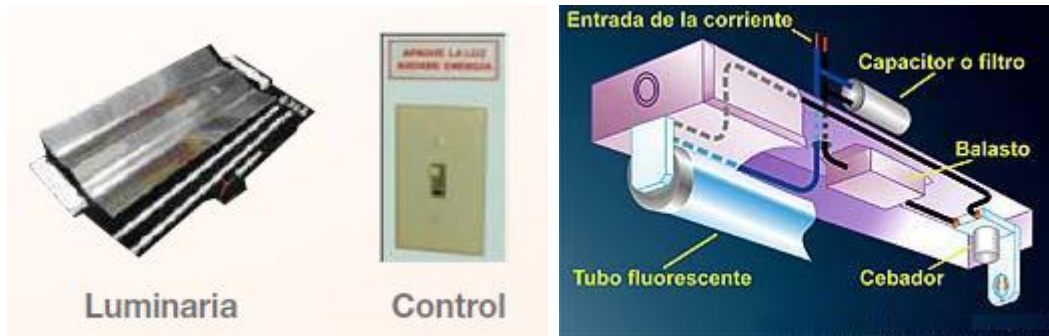
Figura 7. Dispositivos que integran un sistema de iluminación
