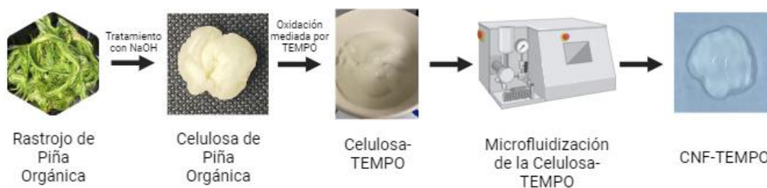
Figura 5. Proceso de Obtención de las nanofibras de celulosa oxidadas con TEMPO (CNF) a partir del rastrojo de piña orgánica (Elaboración Propia)
