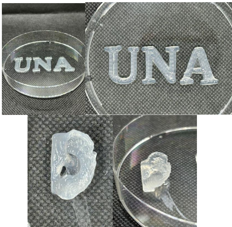
Figura 12. Imágenes de la impresión 3D de figuras complejas: el logo de la Universidad Nacional de Costa Rica y una oreja humana impresas en la bioimpresora con la formulación CNF:PVA 1:1
