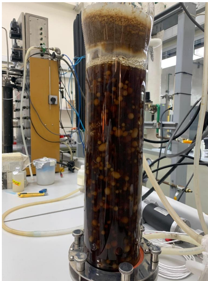
Figura 5. Fermentación (CB7_01) en columna de burbujas en medio de hidrolizado suplementado con glucosa y extracto de levadura a las 72 horas de fermentación, se observa la formación de pellets a lo largo de toda la columna.
