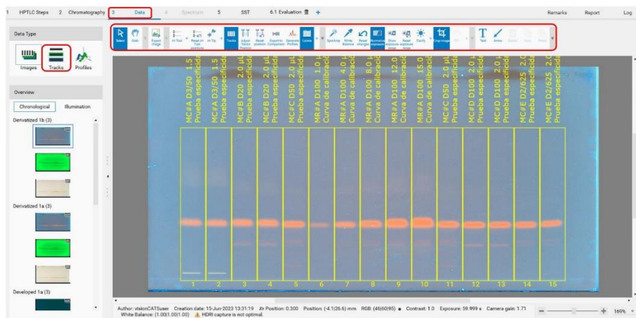
Figura 3. Datos adquiridos por el “TLC Visualizer 2” durante el análisis de CBD por HPTLC en muestras de aceites comerciales enriquecidas con extracto de cáñamo.
