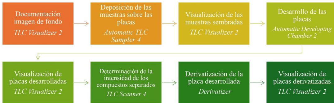
Figura 1. Diagrama general del proceso de análisis de CBD por HPTLC en muestras de aceites comerciales enriquecidas con extracto de cáñamo.
