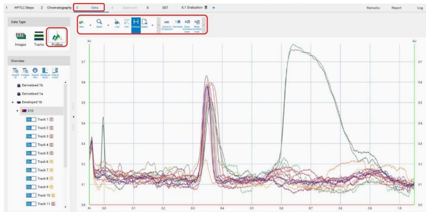
Figura 4. Perfiles adquiridos por el “TLC Scanner 4” durante el análisis de CBD por HPTLC en muestras de aceites comerciales enriquecidas con extracto de cáñamo.
