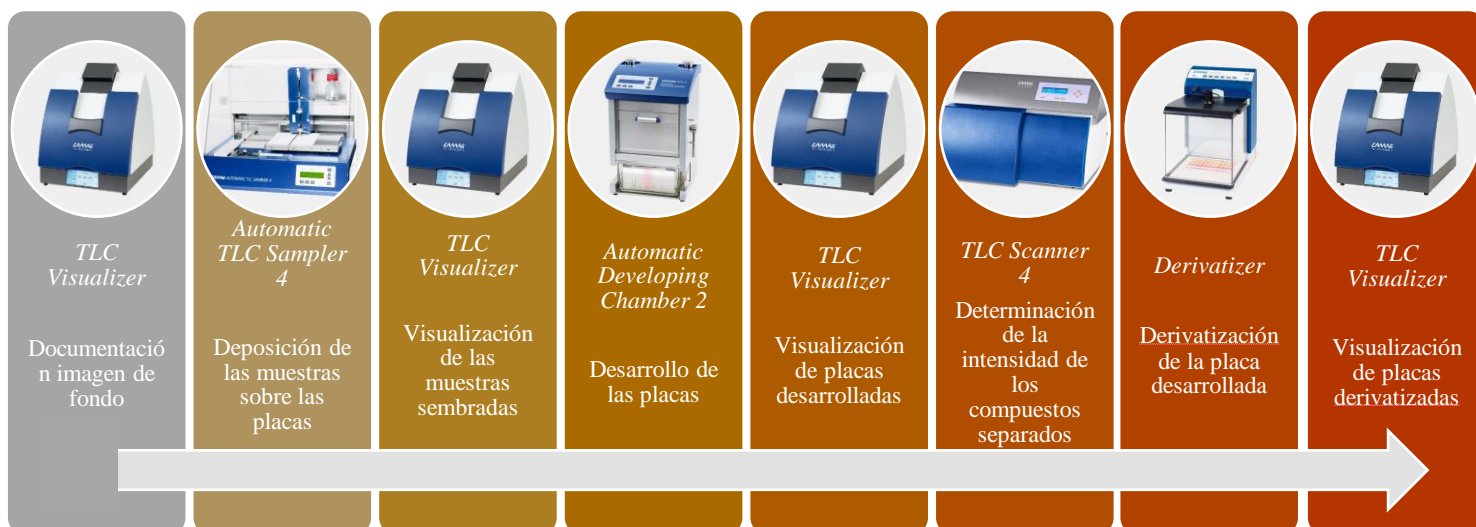
Figura 4. Diagrama general del proceso de análisis de CBD por HPTLC en muestras de aceites comerciales enriquecidas con extracto de cáñamo.
