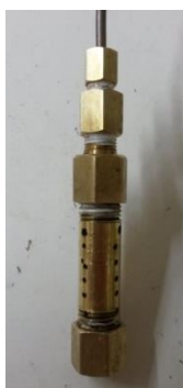
Figura 12. Sonda utilizada para capturar gases efecto invernadero en el interior de un montículo de pulpa residual de café (elaboración propia, 2016).
