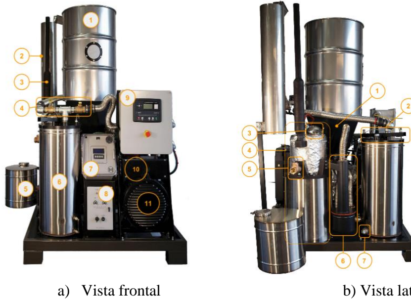
Figura 5. Componentes de un sistema Power Pellet: a) 1. Tolva de materia prima 2. Llama 3. Pila de escape 4. Válvulas para el gas de la llama y el motor. 5. Recipiente de recogida de cenizas - Este buque tiene suficiente capacidad para manejar 1 224 horas de tiempo de funcionamiento. 6. Filtro del gas. 7. PCU (Proceso de Control Unitario) 8. Panel de operaciones 9. Caja de control de la rejilla 10. Caja de configuración eléctrica 11. Generador. b) 1. Cubo de secado 2. Palanca de bloqueo de tapa del filtro de gas 3. Ventana de visualización del reactor de pirolisis 4. Gasificador 5. Válvula de retención de entrada de aire 6. Ciclones y cenizas ciclónicas 7. Tapón de drenaje del filtro de gas.
