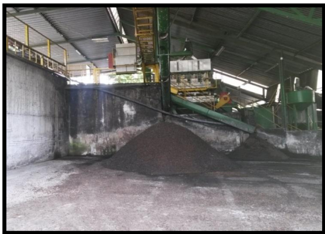
Figura 49. Área de almacenamiento temporal de la pulpa residual en el Beneficio de Coopro- San Vito, 2015.
