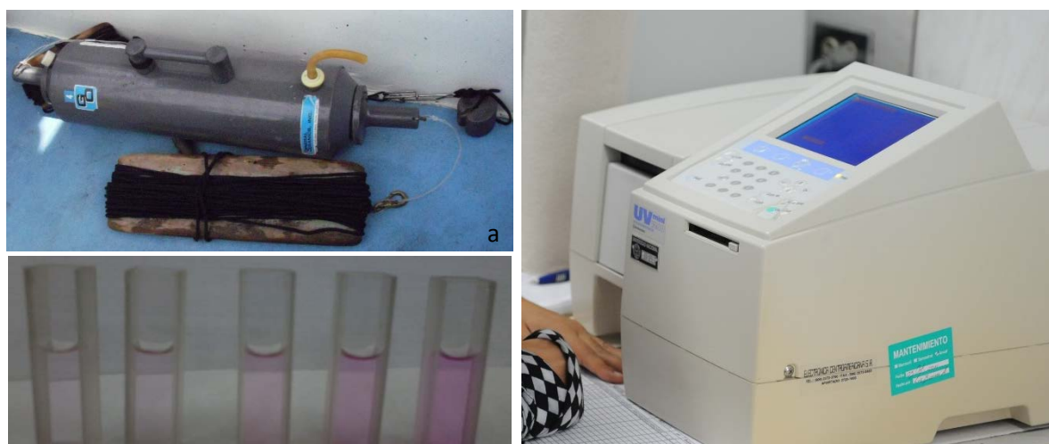
Figura 4. Toma y análisis de muestras: a) Botella Niskin, b) muestras teñidas y c) espectrofotómetro
