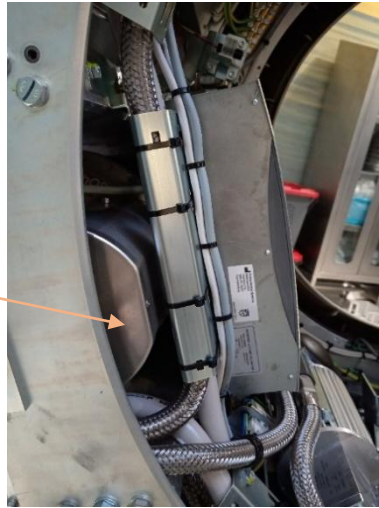
Figura 2. Tubo de Rayos X de un CT, marca Philips, modelo iCT, Servicio de Radiología e Imágenes Médicas del Hospital San Juan de Dios, San José, Costa Rica.
