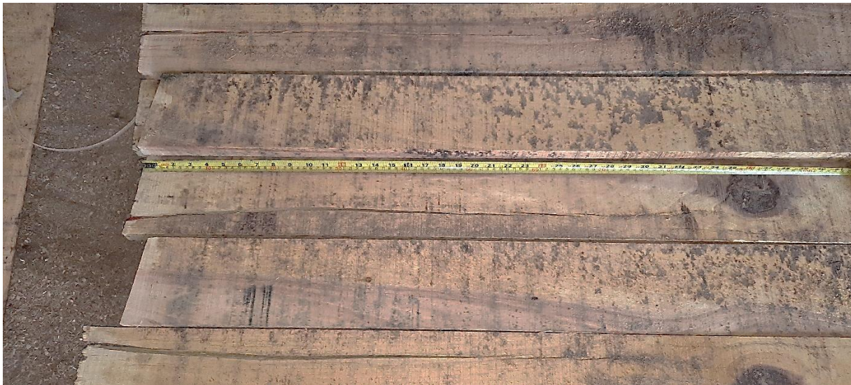
Figura 27. Defecto de rajadura más frecuente encontrado después del aserrado de la madera en piezas de 31 mm grueso, y 125 mm de ancho.
