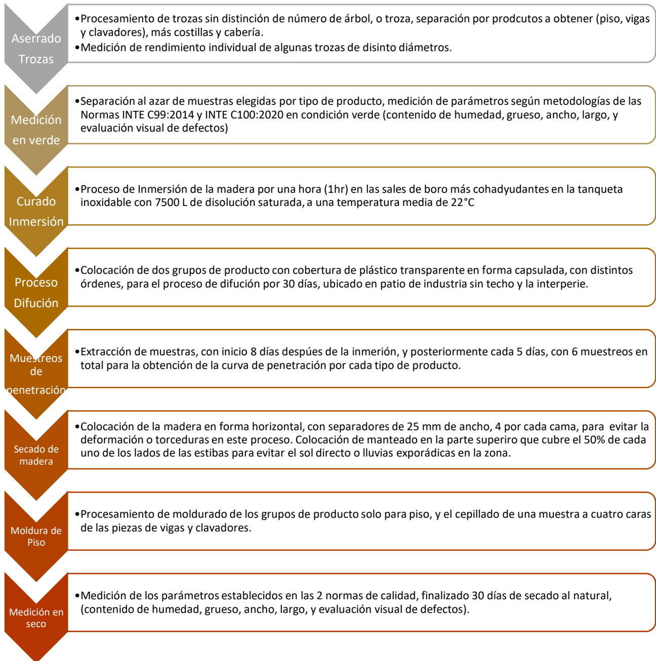
Figura 7. Metodología de trabajo para la aplicación de las normas de calidad INTE C99:2014, INTE C100:2020 y evaluación de T. amazonia proveniente de la empresa BARCA S.A. Proceso general
