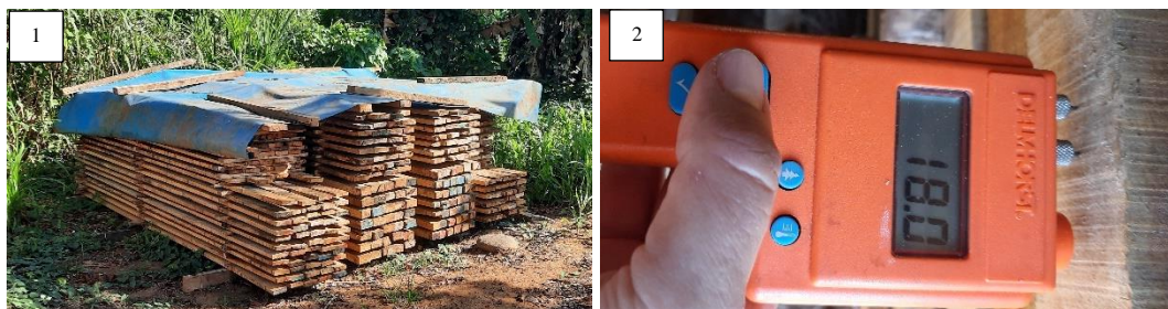
Figura 9. (1) Apilado de muestras para secado al natural con separadores horizontales, (2) Medición de humedad a los 30 días de proceso
