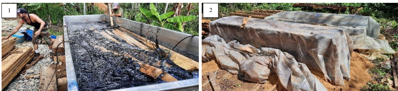
Figura 13. Proceso de inmersión de la madera para el tratamiento en sales de boro, y proceso de difusión en dos pilas por un periodo de 30 días
