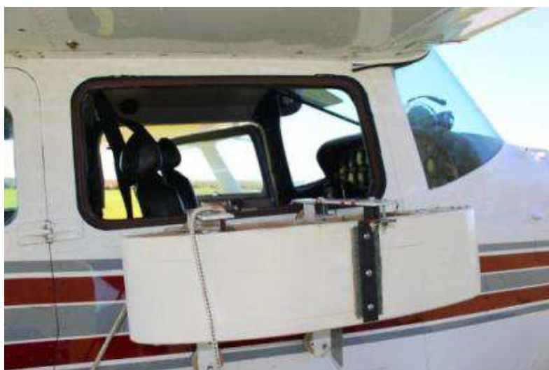
Figura 12. Imagen de la consola acoplada a un avión CESSNA 206 donde se introduce la cámara fotográfica para realizar los muestreos aéreos con fotografías para estimar la población de venados de las pampas en San Alonso, en la Reserva Natural Iberá, Provincia de Corrientes, Argentina, 2016.
