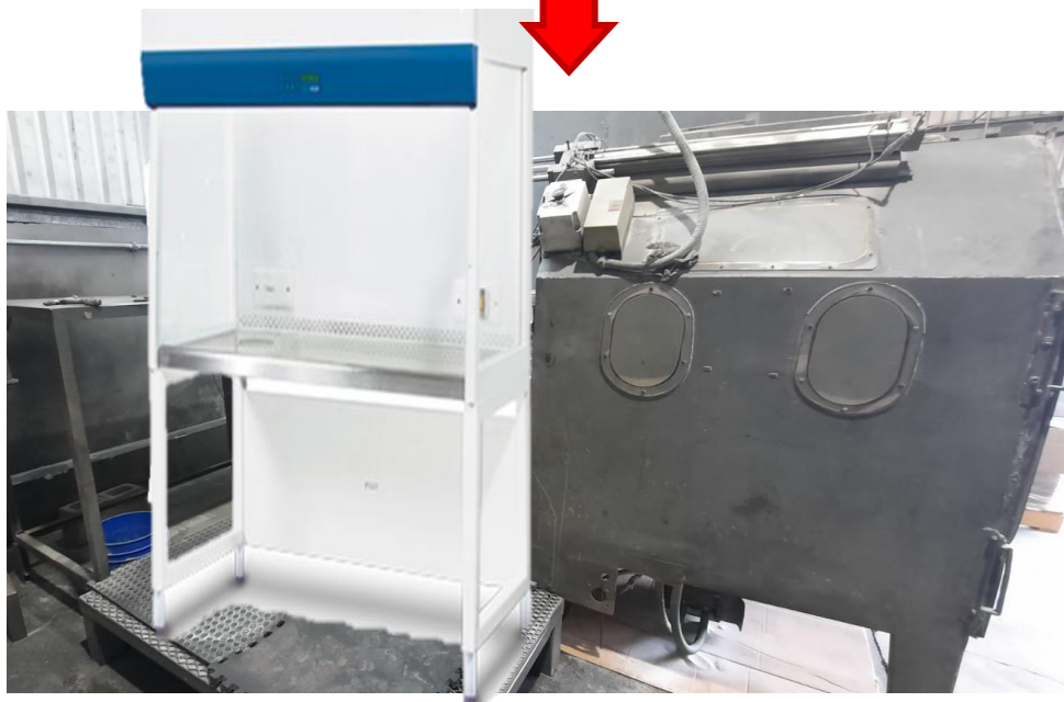
Figura 21. Medida de control #13: se propone la colocación de capillas de extracción en las mesas de trabajo de TR con el fin de reducir la liberación de polvo en el ambiente de trabajo.
