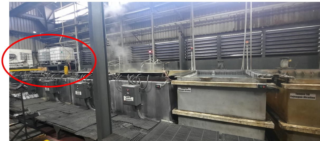
Figura 15. Medida de control #6: actualmente ya se cuenta con el uso de totes en la parte izquierda de los baños de lavado. La recomendación es hacer un mejor uso de estos espacios, de modo que se coloquen totes de cada agente en el lugar correspondiente con el fin de realizar las recargas por medio de algún sistema mecanizado automático. Aplica lo mismo para la línea de pintura y sandblasting.
