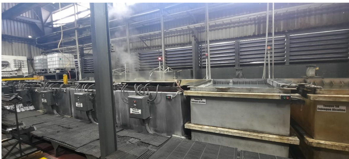
Figura 3. Área de trabajo del puesto TS-a donde se muestran los baños de lavado, así como los totes contenedores (izquierda-arriba) de los cuales se extrae materia prima para los refuerzos.
