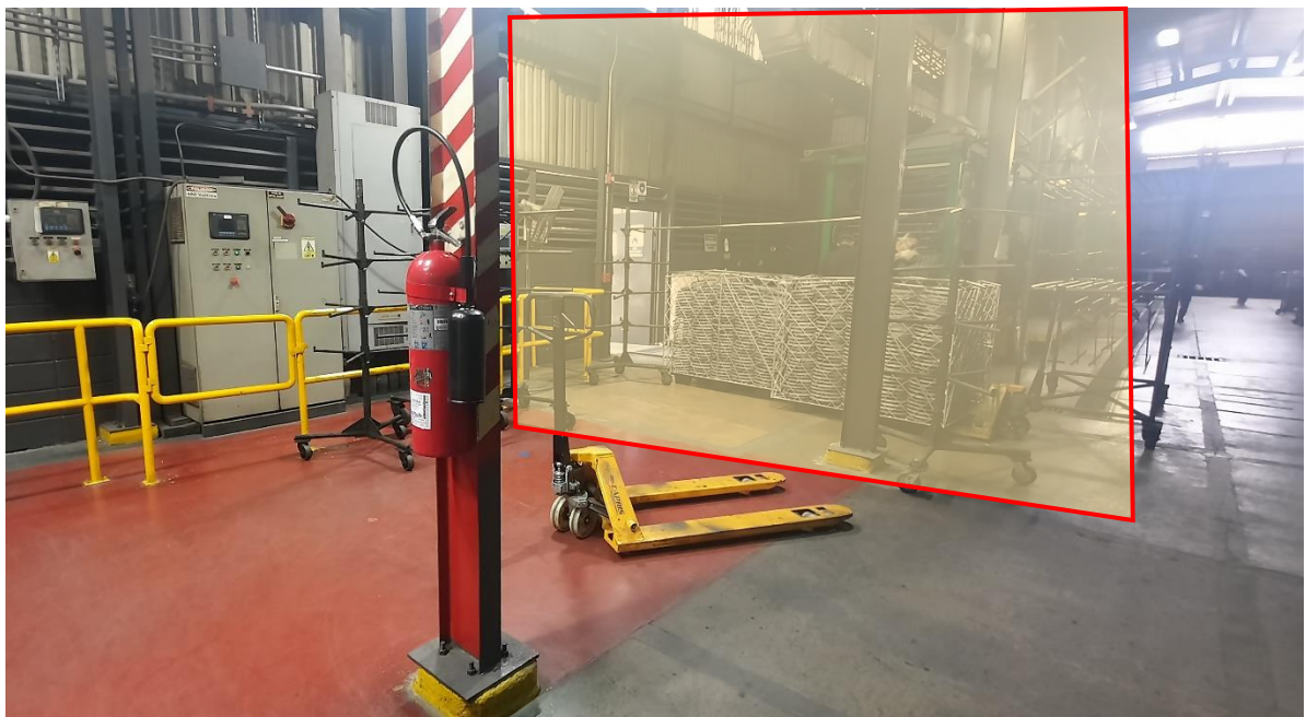
Figura 18. Medida de control #10: se propone la colocación de una separación física entre áreas de trabajo del mismo recinto (en donde solo se deje espacio para la pasada con las perras hidráulicas).
