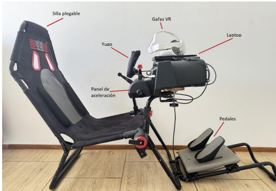
Figura 2. Vista lateral del simulador utilizado, que incluye laptop, gafas, yugo, panel de aceleración y pedales instalados en una silla plegable.
