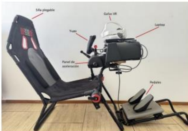
Figura 1. Vista lateral del simulador utilizado, que incluye laptop, gafas, yugo, panel de aceleración y pedales instalados en una silla plegable. Elaboración propia.
