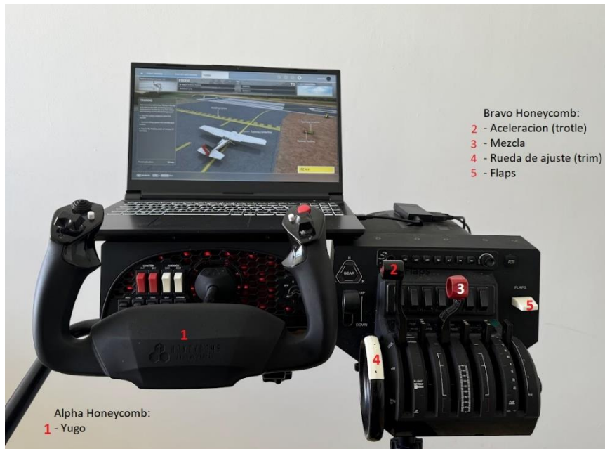
Figura 3. Vista frontal del simulador utilizado, que incluye laptop, yugo y panel de aceleración.
