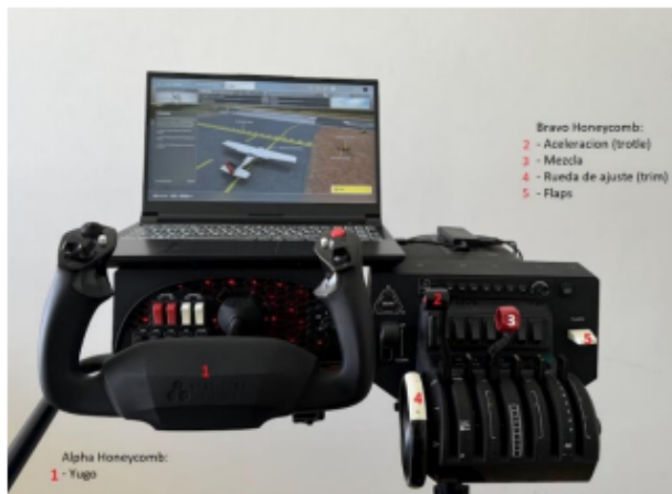
Figura 2. Vista frontal del simulador utilizado, que incluye laptop, yugo y panel de aceleración. Elaboración propia.
