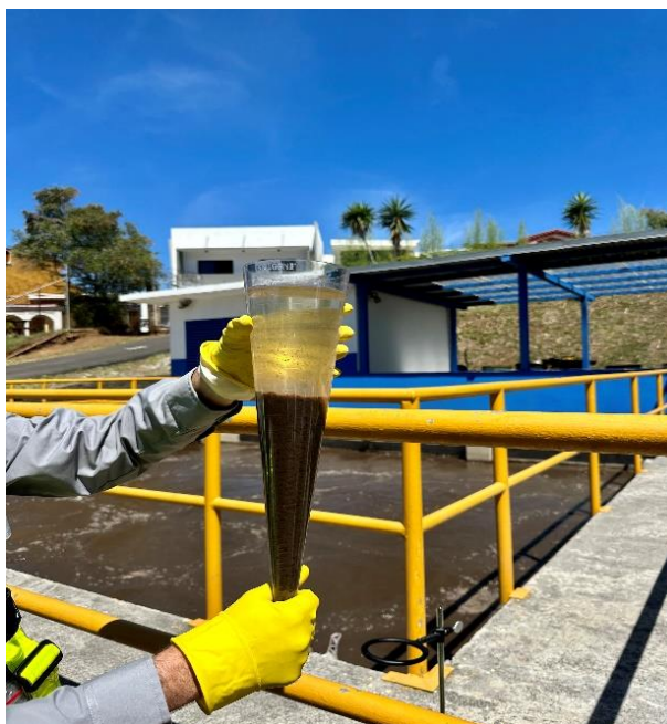
Figura 6.1. Ejemplo de toma de muestra del reactor biológico para la medición volumétrica y control de la concentración de biomasa.
