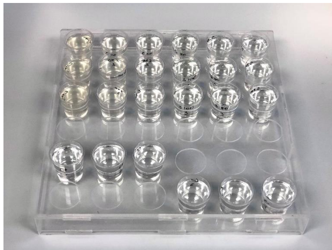
Figura 6.4. Prueba de toxicidad aplicada a Macrothrix elegans con diferentes concentraciones de los efluentes de la PTAR.
