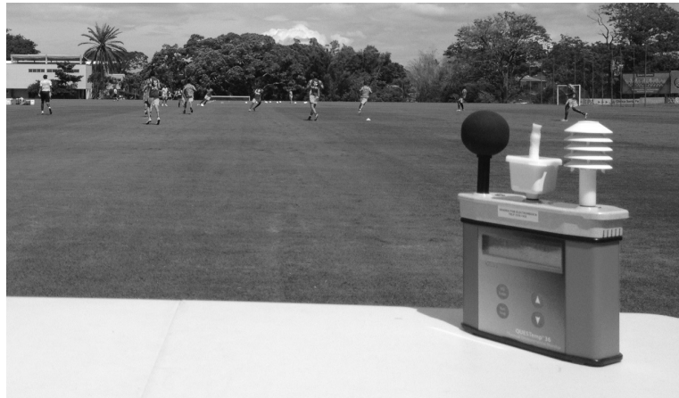
Imagen 6. Equipo para evaluación del estrés termal (Elaboración Propia).
