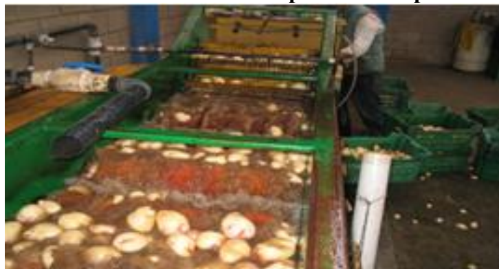
Figura 11: Proceso de lavado de la Papa en una empresa en Pacayas
