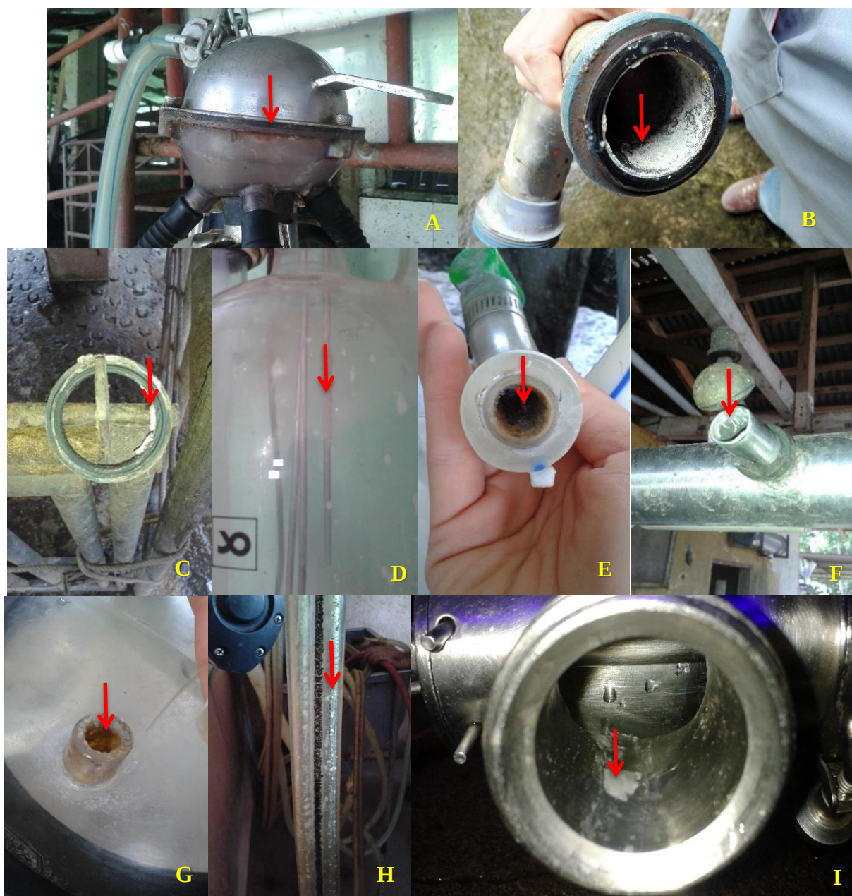
Figura 8. Distintos aspectos de deficiente limpieza y desinfección en equipo de ordeño. A. Colector de leche con suciedad. B. Tubería de leche con residuos de leche. C. Empaque de la tubería sucio. D. Recibidor de leche con residuos. E. Manguera de leche con suciedad. F. Entrada a tubería de leche con residuos y con la tapa dañada. G. Entrada a tarro de leche con suciedad. H. Manguera de vacío con residuos. I. Llave de salida de leche del tanque con residuos.
