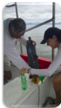
Figura 4. Recolecta de muestras de agua con una botella oceanográfica Niskin para los análisis cuantitativos del fitoplancton.
