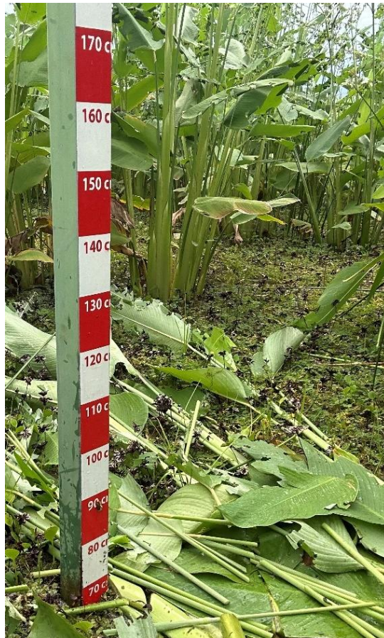
Figura 5.2 Instrumento de medición de los niveles de agua del humedal PNPV.
