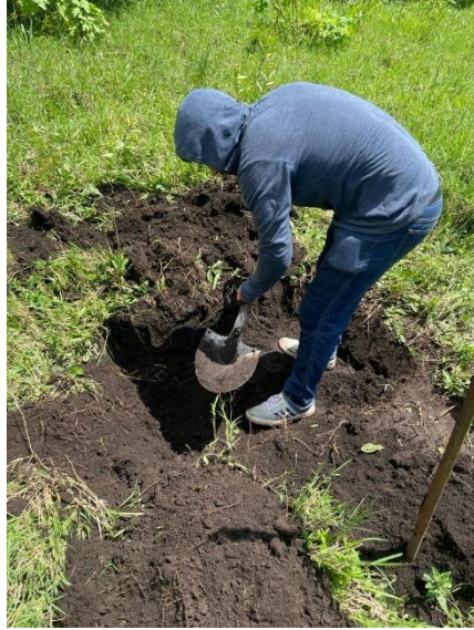
Figura 5.3. Realización de las gavetas para las pruebas de infiltración.
