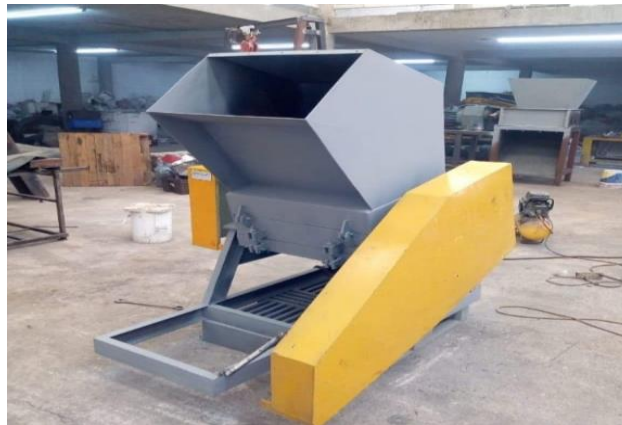
Figura 14: Molino 20 HP, Imagen tomada con fines ilustrativos de Facebook Recitab Tabasco México. (2019)
