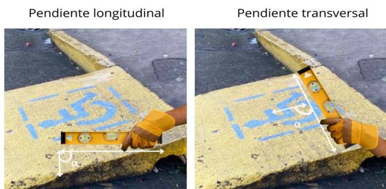
**Figura 8.** Medición de pendiente transversal y longitudinal en rampa de acera.
