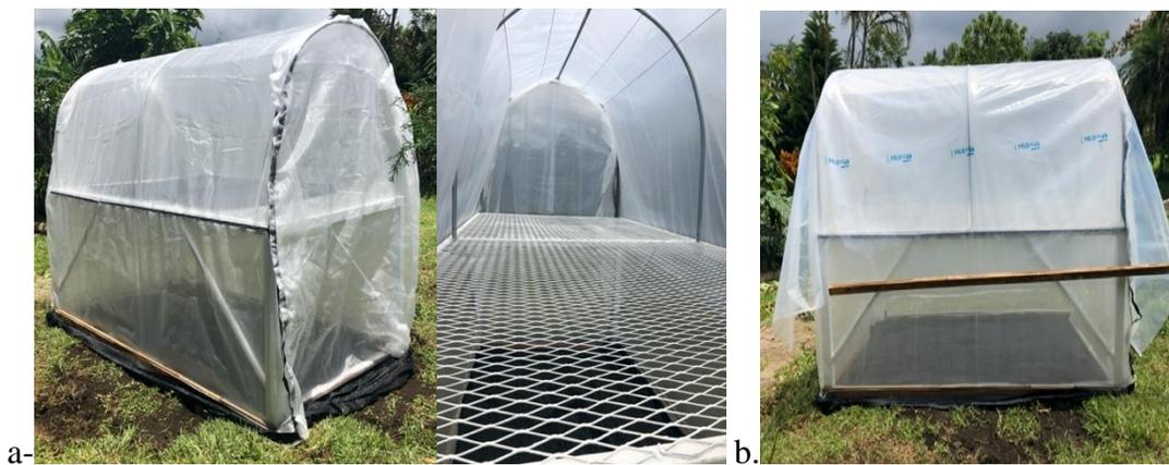
**Figura 1.** Diseño estructural y funcional de la mesa Invernadero; a). Mesa invernadero cubierta maya antiafida, apertura lateral, b) capota plástica para evitar exposición a la lluvia.
