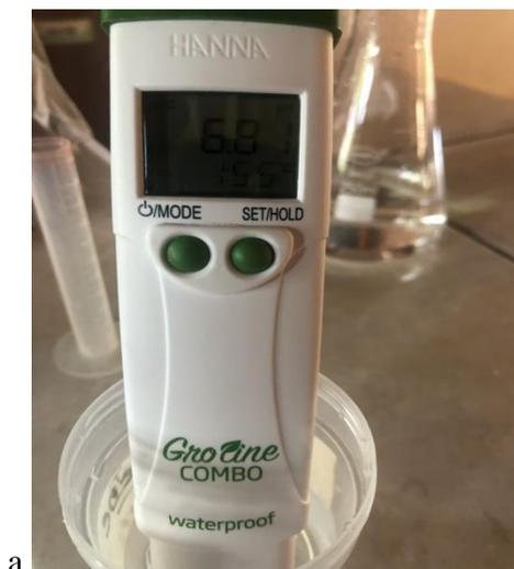
**Figura 3.** Metodología empleada en la medición de conductividad y pH de la solución nutritiva; a) Tester a utilizarse.
