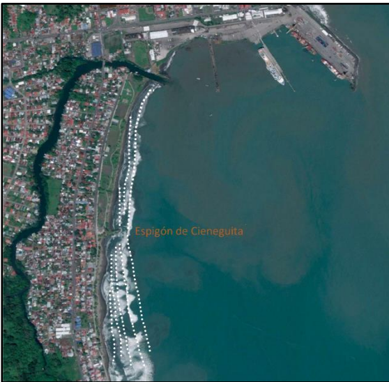
Figura 12. Dirección de incidencia del oleaje respecto a la playa de Cieneguita. Las líneas punteadas indican la posición del tren de olas. Nótese que las olas arriban primero en la sección norte de la playa lo que debe general un corriente de deriva en dirección sur. Fuente: Google Earth, imagen tomada el 23/02/2018. Elaboración propia.
