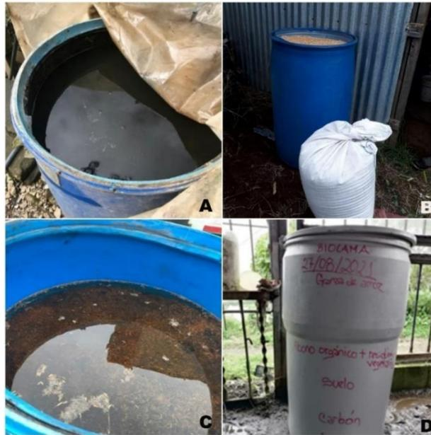
*Figura 29.* Biocamas experimentales en cada finca: (A) biocama A inundada; (B) biocama B construida fuera de la bodega al aire libre, pero cerrada herméticamente mediante lámina y peso; (C) biocama C inundada al final del estudio; y, (D) biocama D construida bajo techo.
