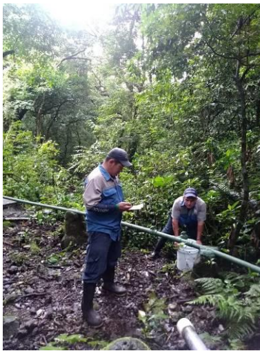
Figura 13. Medición de caudal por parte del personal de la ASADA. (ASADA San Pedro, 2019)
