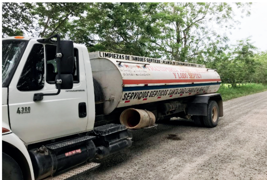
Figura 4 Camión cisterna recolector de lodos séptico
