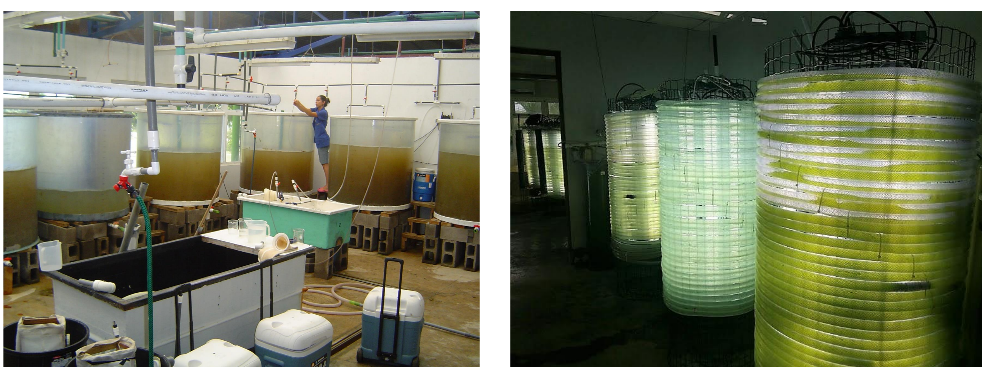
Fig. 2: Producción de Rotíferos y Microalgas en Fotobiorreactores Helicoidales
