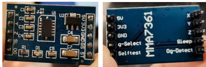
Figura 25. Acelerómetro MMA7361, vista superior e inferior del módulo Fuente: Creación propia, 2021
