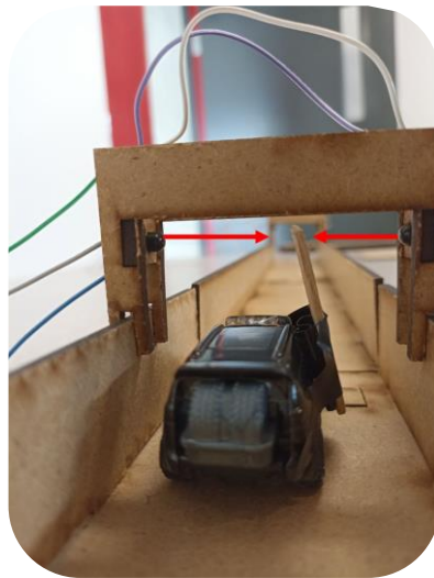
Figura 37. Carrito con bandera cortando el haz de luz
