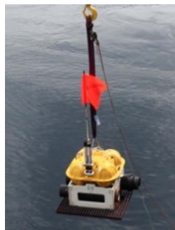
Figura 3: Izda. Buque oceanográfico Sarmiento de Gamboa que desarrollará la campaña marina en el área del Golfo de Honduras. Drcha. Sismómetro de Fondo Oceánico (OBS) que se fondeará en el área de estudio.
