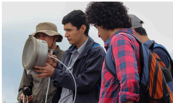
Figura 2. Captura de datos de concentración de CO 2 del aire del ambiente.
