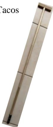
Elemento de madera pino con una medida de una pieza vertical de un metro de largo, con otra pieza horizontal de 15 centímetros de largo con velcro en sus extremos; posee una agarradera de hule en su cabecera.
