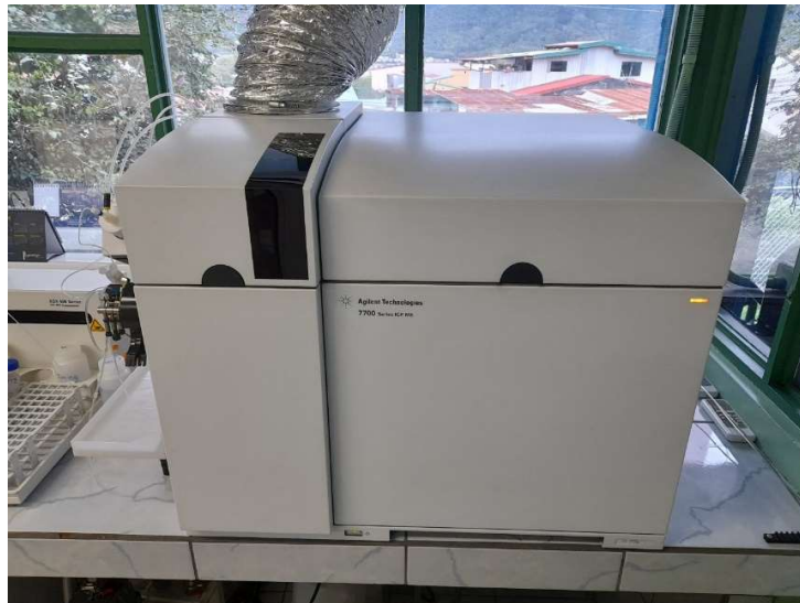
Figura 4. Acoplador de plasma inductivo con detector de masas para el análisis de muestras de metales.
