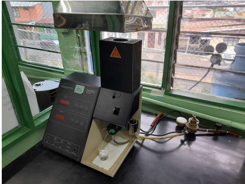
Figura 5. Fotómetro de llama Perkin Elmer modelo 2655-10 Dual Channel Flame Photometer.
