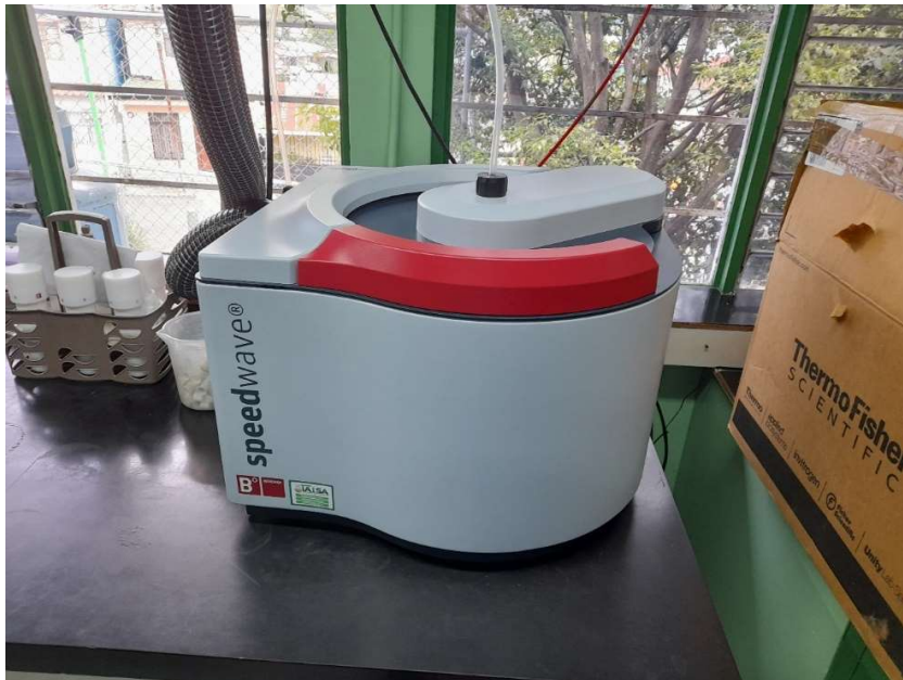
Figura 3. Digestor de microondas con sistema de centrifuga Berhoff Speedwave Xpert.
