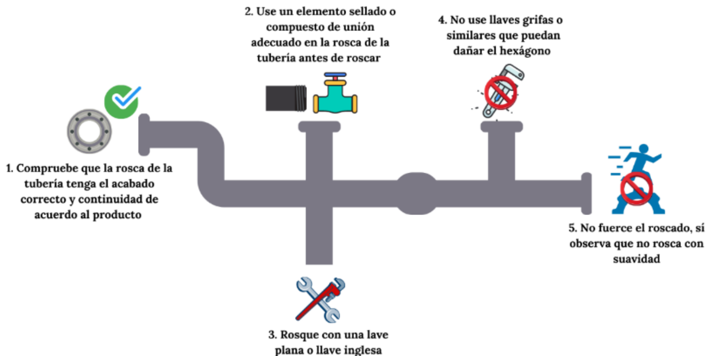
Figura 13. Instalación de válvulas con conexiones roscadas.
