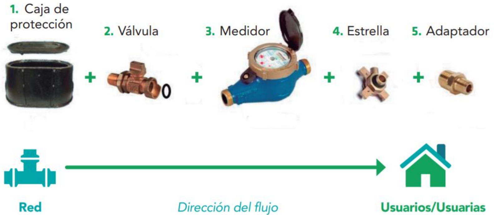
Figura 10. Esquema de armado de un micromedidor.
