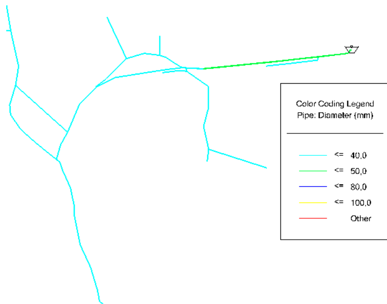
Figura 31. Diámetros del modelo 4. Del tanque de almacenamiento al pueblo de Buena Vista-Modelo actual
