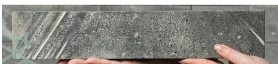
Figura 1. Ladrillo con biocemento producido por BioMASON.
