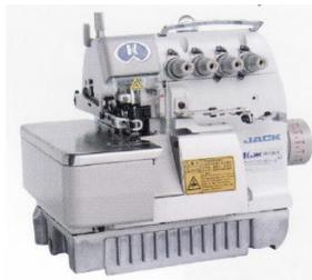
**Figura 25. Máquina overlock industrial marca Jack JK 768**
