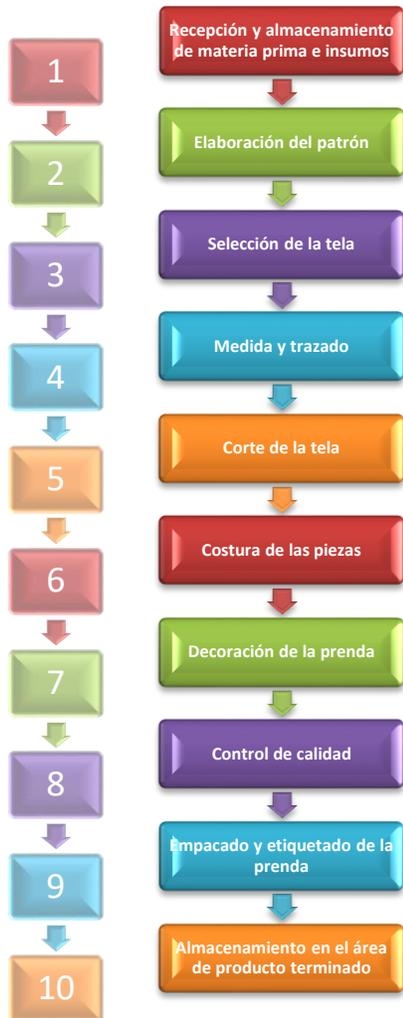
**Figura 23. Diagrama de flujo de proceso**
