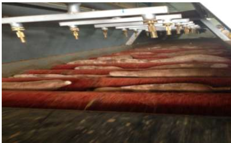
Figura 41. Lavadora de tubérculos, en seco, imagen de empresa Tropi Fruits
