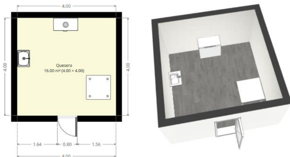
Figura 15 Distribución de planta y equipo.
